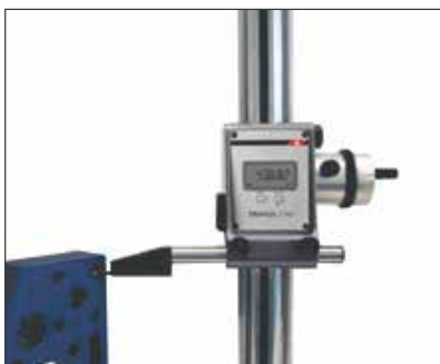
Mesure de diamètre avec touche bidirectionnelle (TVM4)
