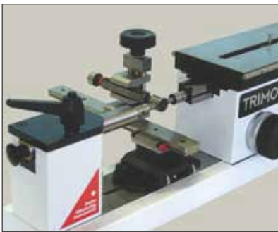
Etalonnage de tampons lisses et filetés avec table flottante (THV-115)
