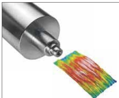
Mesure des vibrations d'usinage sur un rouleau d'impression en acier (DHM S2)
