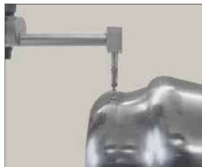
Mesure d'état de surface sur une pièce polie (TA-MS-607)
