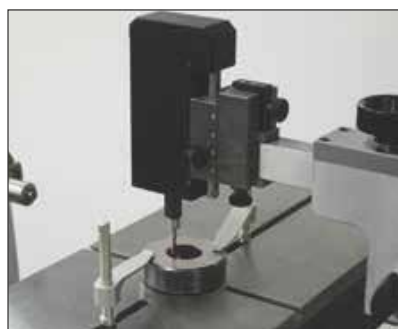
Etalonnage de petites bagues lisses (TA-MS-370/TEL76/TA-SU-354)
