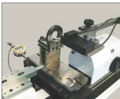
Mesure de bagues à filetage conique (HPA-1/LABC80)
