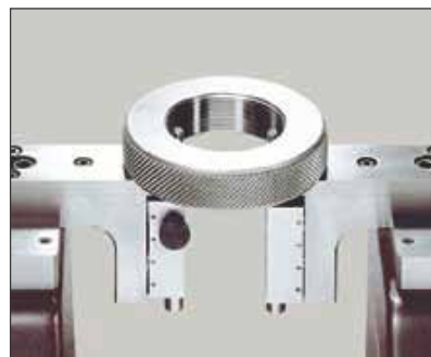
HPA: Contrôle de bagues filetées (TEL18)
