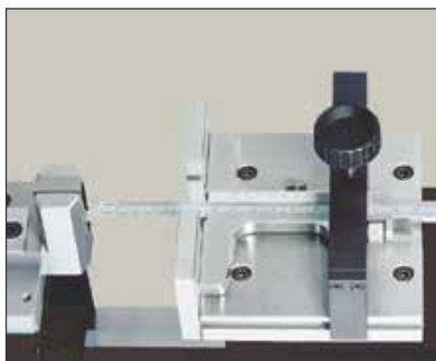
Contrôle de jauges de profondeur (TEL5/TULM19)
