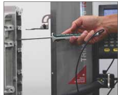
Compensation en température en standard sur tous les modèles et option avec sonde externe (TA-EL-120)
