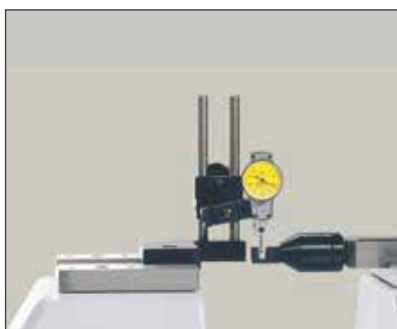
Vérification de comparateurs à levier (TULM15)
