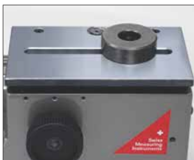
Mesure de diamètres intérieurs (TELS10)
