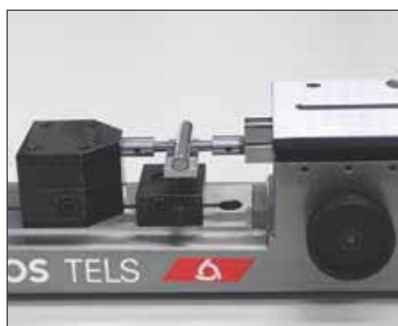
Mesure de diamètres extérieurs (TELS50, TELS5, TELS5.1)
