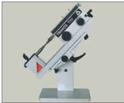
Support inclinable pour garantir une force de mesure constante (THV-200)
