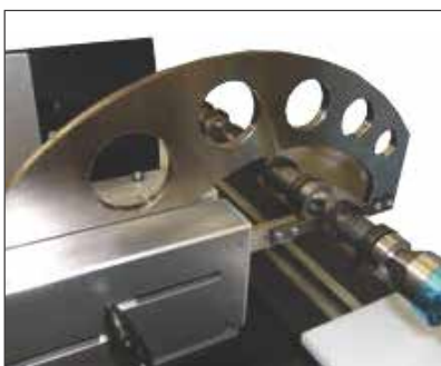
Mesure de diamètres sur un arbre à came
