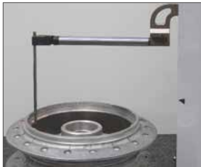
Mesure de gorges avec porte-touche à 90° et touche en « L » (TA-IH-105/V.50.5/V-50.3)
