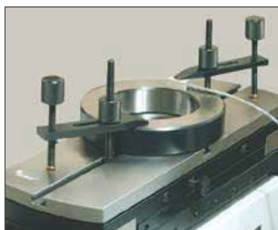
Système de compensation en température TempComp
