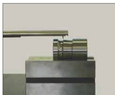
Mesure de contour avec TR Profile DH-8/VHF (TA-MS-650)
