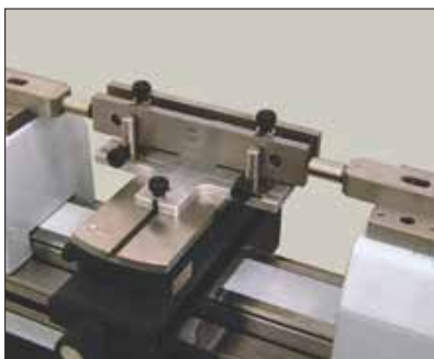
Contrôle comparatif de cales-étalons < 250 mm (TA-SU-313/TA-SU-305)
