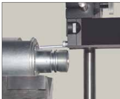
Mesure de rugosité proche d'un épaulement (TA-MS-601)
