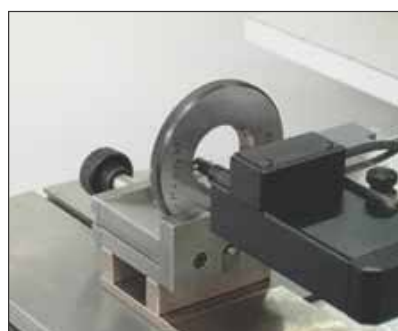
Etalonnage de bagues à filetage conique (TA-MS-381/TEL75)
