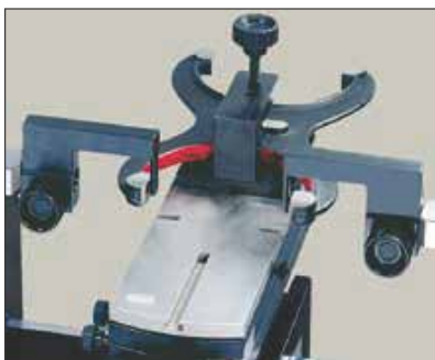
Vérification de calibres-mâchoires (TA-SU-313/TEL14N)
