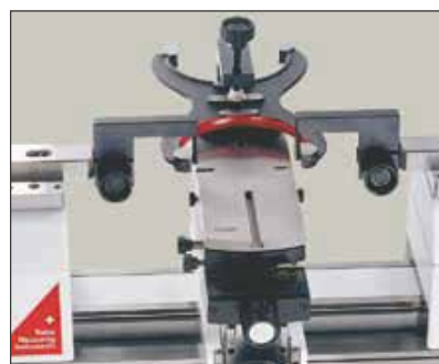
Vérification de calibres-mâchoires (TA-SU-313/TEL14N)
