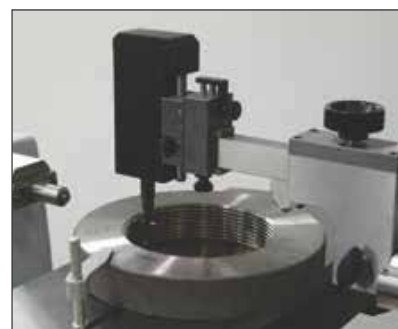
Etalonnage de bagues filetées (TA-MS-370/TEL75/TA-SU-354)
