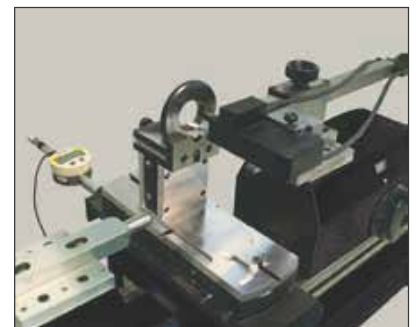
HPD: Mesure de bagues à filetage conique (LABC80)
