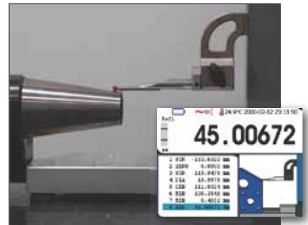
Mesure d'angles et de cônes assistée graphiquement (TA-MI-101/TA-AD-101)
