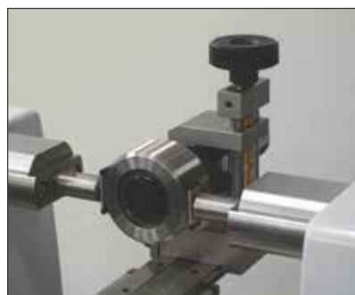
Etalonnage de tampons filetés (3P/0.17-3.2/S6.5/TA-SU-315)
