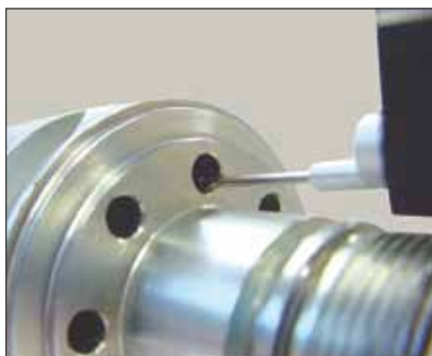
Mesure dans un alésage de faible diamètre (TA-MS-605)
