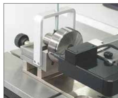
Etalonnage de tampons à filetage conique (TA-MS-381/TEL75)
