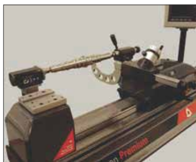
HPA: Mesure de pièces cylindriques (TA-MS-303)
