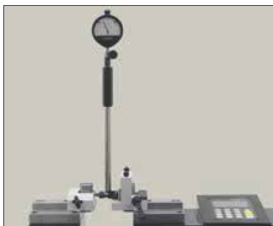
Etalonnage de vérificateurs d'alésages à 2 points (TEL5/TA-SU-301)
