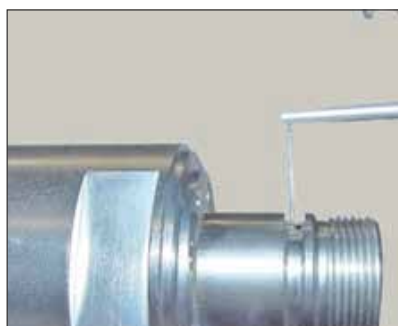
Mesure de rugosité dans une gorge (TA-MS-609)
