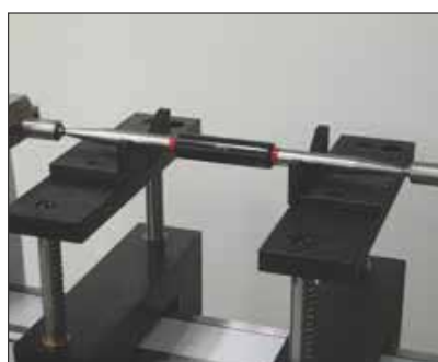
Etalonnage de tiges-étalons (TELMA7/TELMN7.2)
