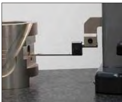
Mesures de petits diamètres et entraxes (V-5/V50.9)
