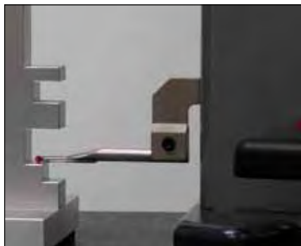
Mesure de hauteurs (TA-MI-101)
