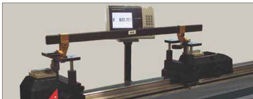
Etalonnage d'une jauge de grande dimension (TEL5)
