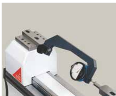
Vérification de comparateurs (TULM5C)
