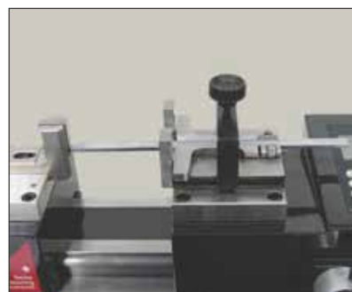
Vérification de jauges de profondeurs (TULM19/TEL5)
