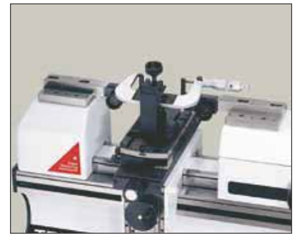
Etalonnage de micromètres extérieurs (HPA-1/TULM14)
