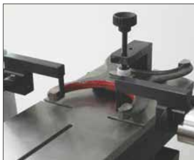
Etalonnage de calibres-mâchoires (TEL16.1/TEL14N)
