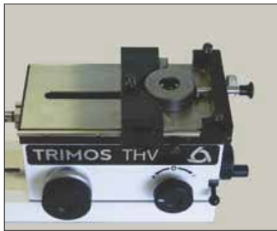
Etalonnage de bagues lisses (THV-260)
