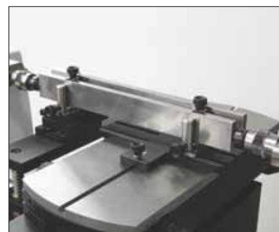
Contrôle comparatif de cales-étalons > 250 mm (TA-SU-307/TEL7/TELMA7)
