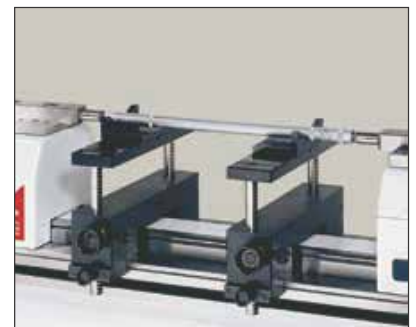
Etalonnage de micromètres d'intérieur à 2 points (HPA-1/TELMA7/TELMN7.2)
