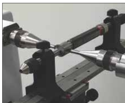
Etalonnage de tampons lisses (TULM6/L05/TA-SU-315)
