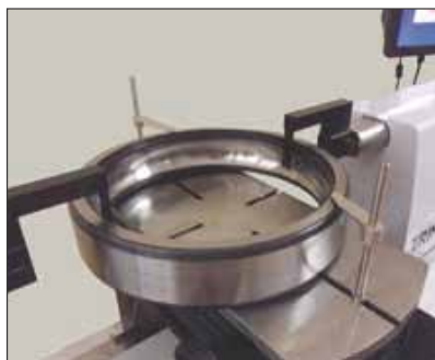
Mesure intérieure automatique d'une bague de roulement à bille
