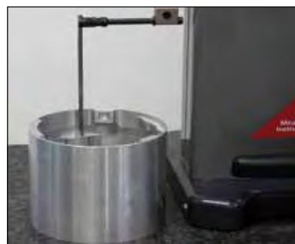
Mesure de profondeurs (TA-IH-109/V-50.5/V-50.4)
