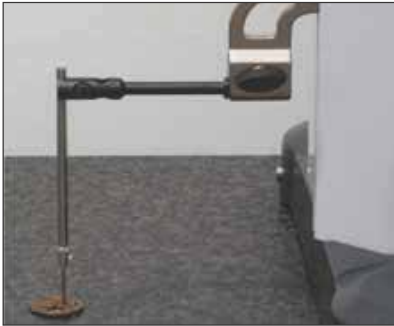
Mesure de hauteurs sur platine de montre (TA-IH-109/V-50.5/TA-MI-118)
