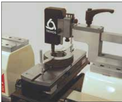
Etalonnage de bagues filetées (TA-SU-313/LABC-70/TA-SU-354)
