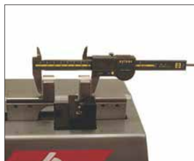
Le contrôle de pied à coulisse, micromètres et comparateurs est également possible.
