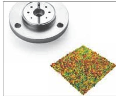
Analyse de texture d'une surface en titane polie chimiquement (DHM S2)
