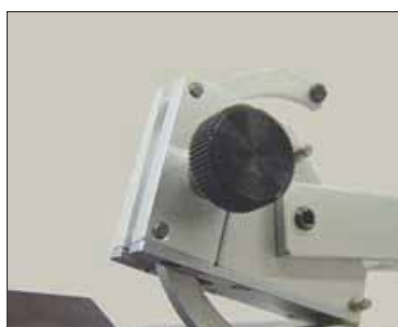
Mesure de rugosité radiale (TA-MS-621)
