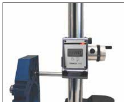
Mesure d'entraxes avec cones (TVM5)
