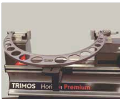
Contrôle de grands micromètres (TEL5/TEL11/LABC20)
