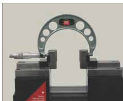
Vérification de micromètres extérieurs (TEL5/TEL11)
