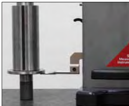
Mesures d'épaisseurs (TA-MI-101)
