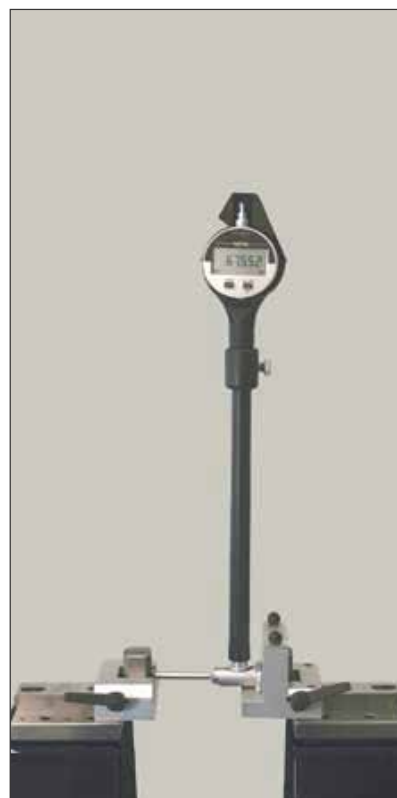
Etalonnage de vérificateurs d'alésages à 2 points (TEL5/TA-SU-301)
