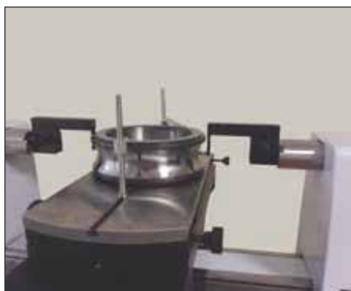
Mesure extérieure automatique d'une bague de roulement à bille
