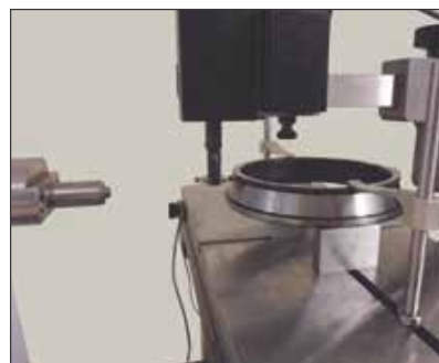
Mesure extérieure automatique d'une bague conique
