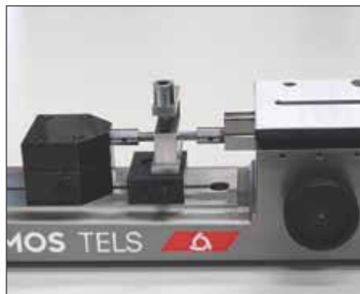
Mesure de longueurs (TELS50, TELS5, TELS5.1)
